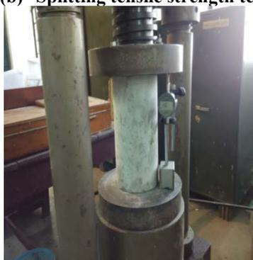
(d) Modulus of elasticity test
